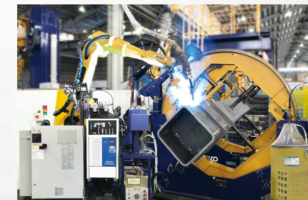
鉄骨溶接ロボット
